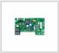
ONE.2WI Récepteur 433,92 MHz 2 canaux à triple codage : Advanced Rolling Code, Rolling Code et Code Fixe, embrochable. 512 codes mémorisables.
