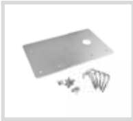
BUFFALO.P160 Base de fondation avec tirants d'ancrage. Fixation du moteur entraxe 490x215 mm n.6 Ø 14,5 mm. Pour les modèles BUFFALO160 OTI / SC.
