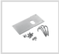
BISON.P45 Base de fondation avec tirefonds et base d'appui pour le réglage en hauteur. Fixation au moteur, entraxe 410x165 mm, n. 4 Ø 14,5 mm. Pour modèle BISON45 OTI.
