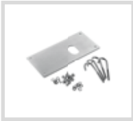
BISON.P35 Base de fondation avec tirefonds et base d'appui pour le réglage en hauteur. Fixation au moteur, entraxe 410x165 mm, n. 4 Ø 13 mm. Pour modèles BISON35 OTI / OTIL.
